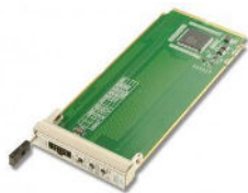
UTC008 MTCA JTAG Switch Module (JSM)
