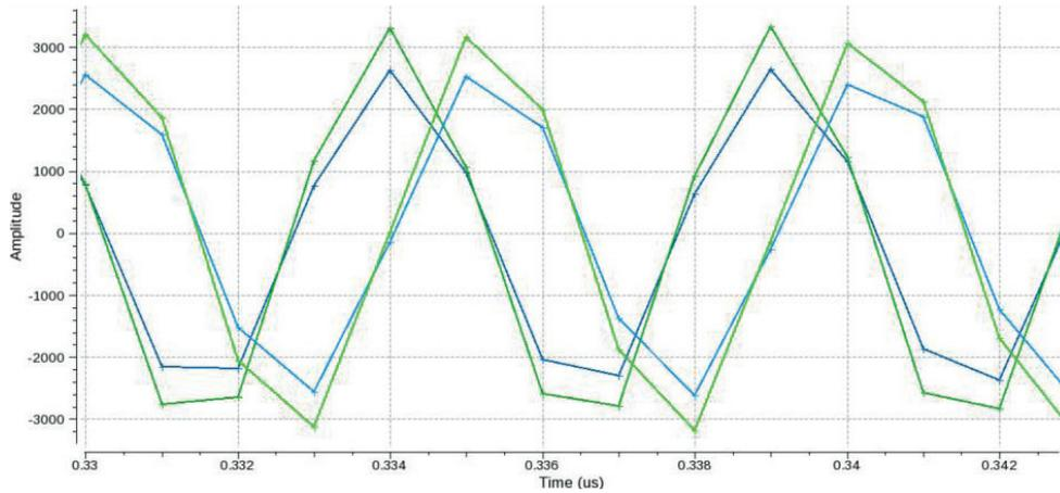
**Figure 29:** Amplitude DDC 2500MHz, input 2302MHz
