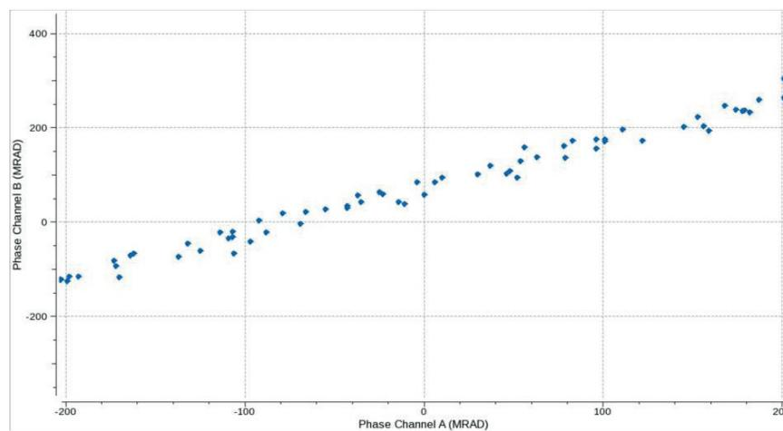
**Figure 25:** Phase error DDC 2500MHz, input 2502MHz
