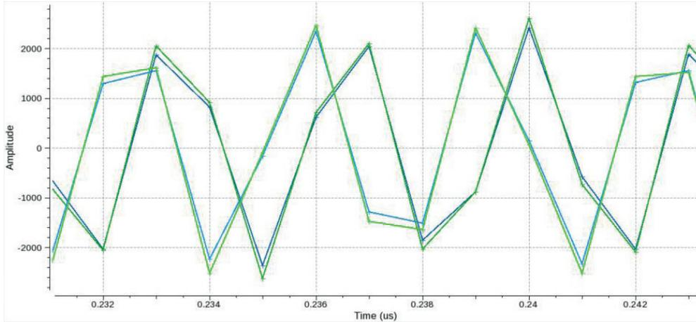
**Figure 26:** Amplitude DDC 2500MHz, input 2800MHz
