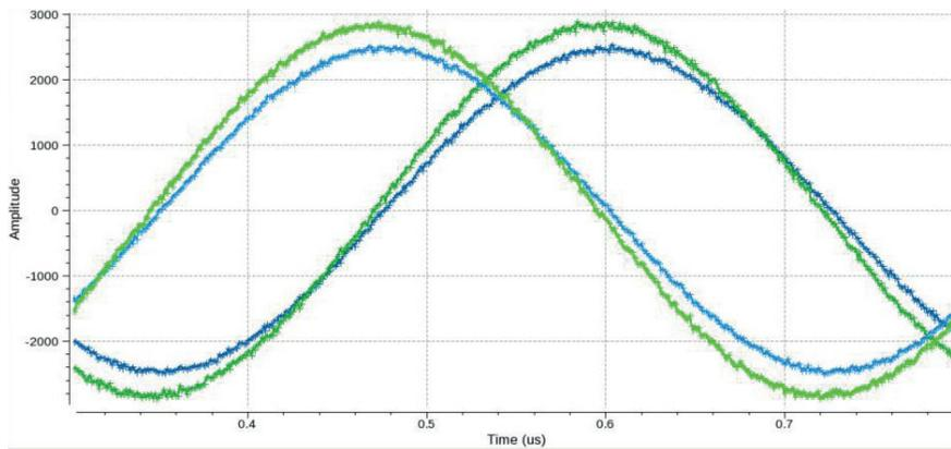
**Figure 23:** Amplitude DDC 2500MHz, input 2502MHz
